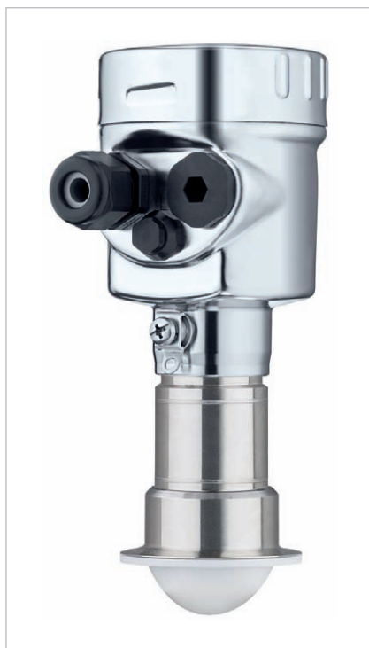
Obr. 2 Snímač Vegapuls 64 môže byť vybavený zapuzdrenou plastovou anténou alebo kovovým systémom so šošovkovou anténou.
