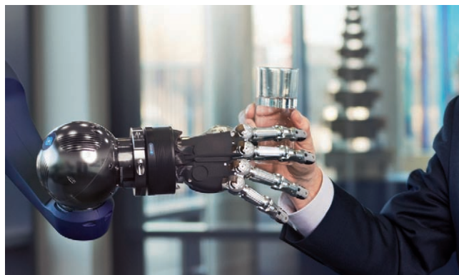
Ruka s piatimi prstami SCHUNK SVH je prvým uchopovačom na svete s certifikátom DGUV, určeným na kolaboratívnu prevádzku.
